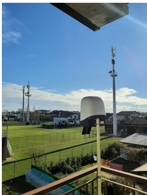
Fig. 4 – Centralina per il monitoraggio in continuo Postazione 1 – Balcone 2° piano
