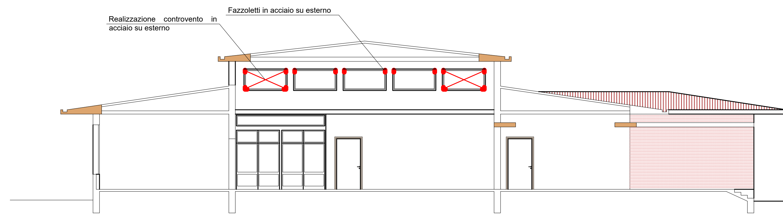
SEZIONE B: TRASVERSALE SCUOLA Scale 1:100
